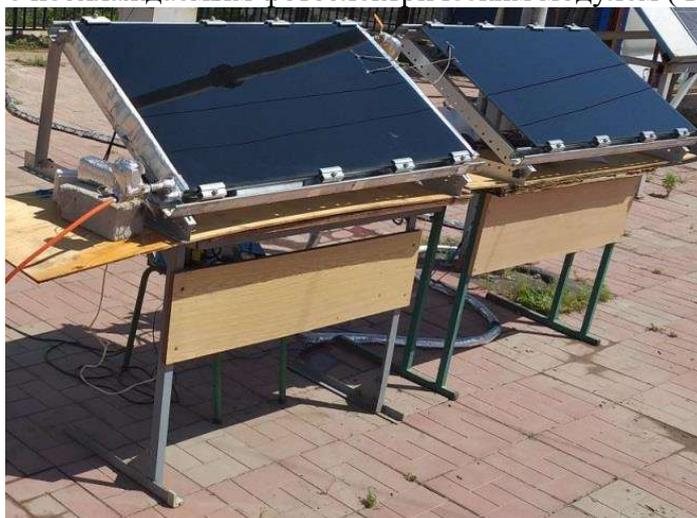
Рис.2. Вид экспериментальных установок ФЭТУ и ФЭМ
