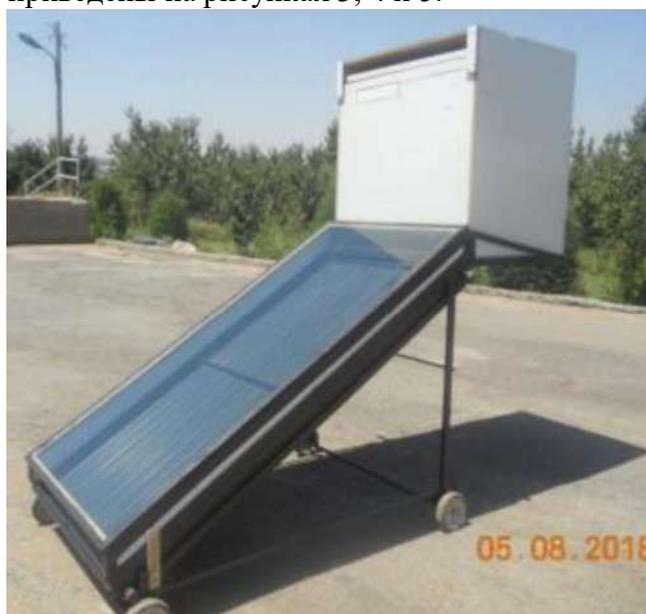
**Рис. 3. Опытный образец солнечной сушильной установок.**
