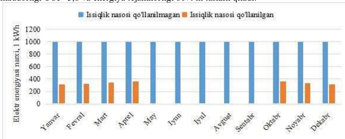
4-rasm. Issiqxonalarda issiqlik nasosidan foydalanish samaradorlik ko'rsatgichlari.
